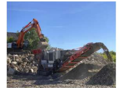
Дробильный комплекс для переработки бетона в щебень
